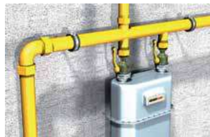
Liczniki gazu, rurociągi gazowe
